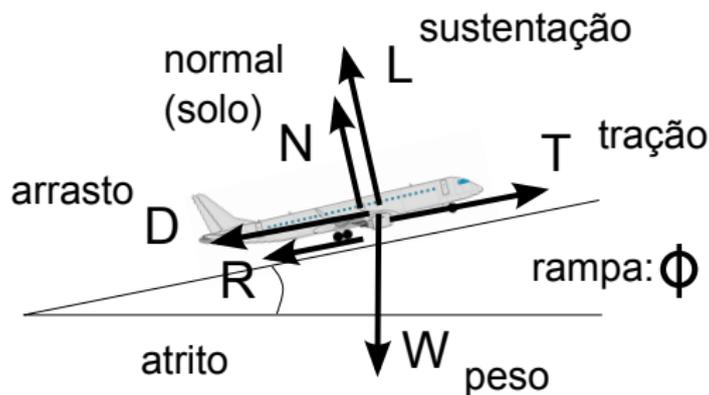
**no eixo horizontal:**  $m \dot{V} = T - D - R - W \sin \phi$
